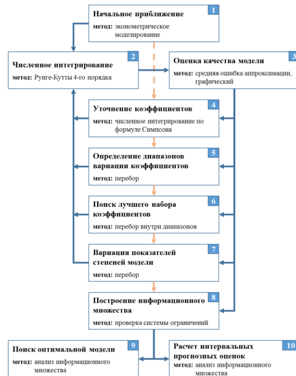
Рис. 4. Графическое изображение логической схемы разработанного подхода.
