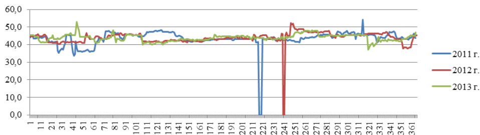
Рис. 1. Изменение избыточного давления в газопроводе на подводном переходе (по вертикали – давление на участке в Мпа -1 , по горизонтали – дни года).
